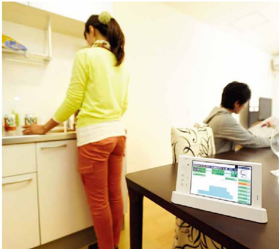
各家庭に設置された「宅内ディスプレイ」。需要状況に応じた電気料金や省エネガイダンスを表示
