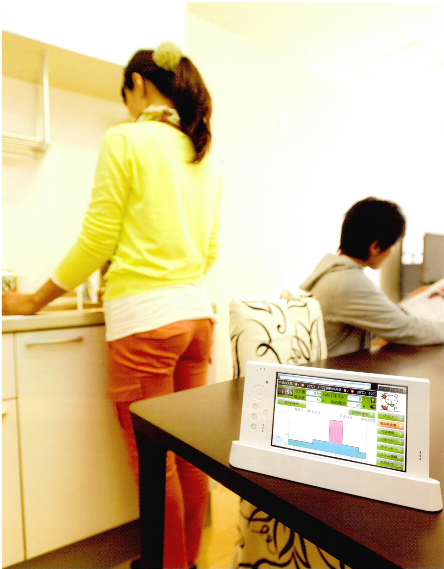
各家庭に設置された「宅内表示器」。 需要状況に応じた電気料金や省エネガイダンスを表示
